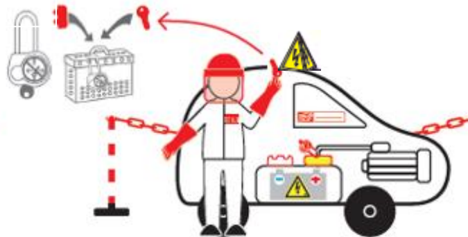
3) Sicherung des Hochvolt-Systems gegen Wiedereinschalten
