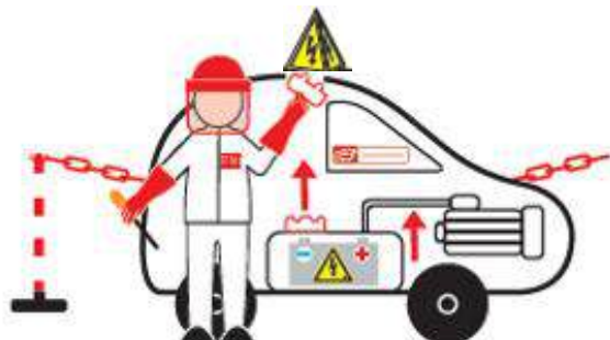
2B) Spannungsfreischaltung des Hochvolt-Systems gem. Sicherheitskonzept des Herstellers
