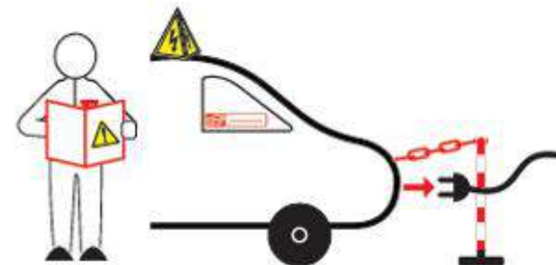
2A) Spannungsfreischaltung des Hochvolt-Systems gem. Sicherheitskonzept des Herstellers
