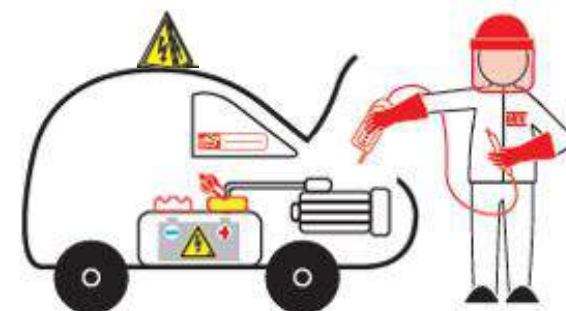
4) Feststellung der Spannungsfreiheit gem. Sicherheitskonzept des Herstellers
