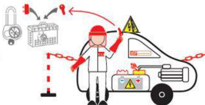
3) Sicherung des Hochvolt-Systems gegen Wiedereinschalten
