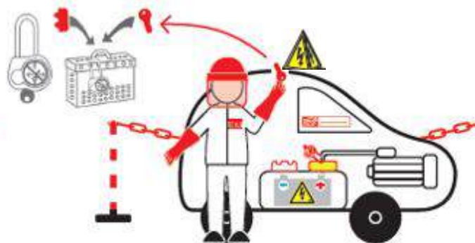
4) Controleer of er geen spanning staat op de aansluitklemmen.
