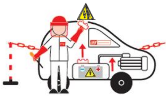
2B) Spannungsfreischaltung des Hochvolt-Systems gem. Sicherheitskonzept des Herstellers
